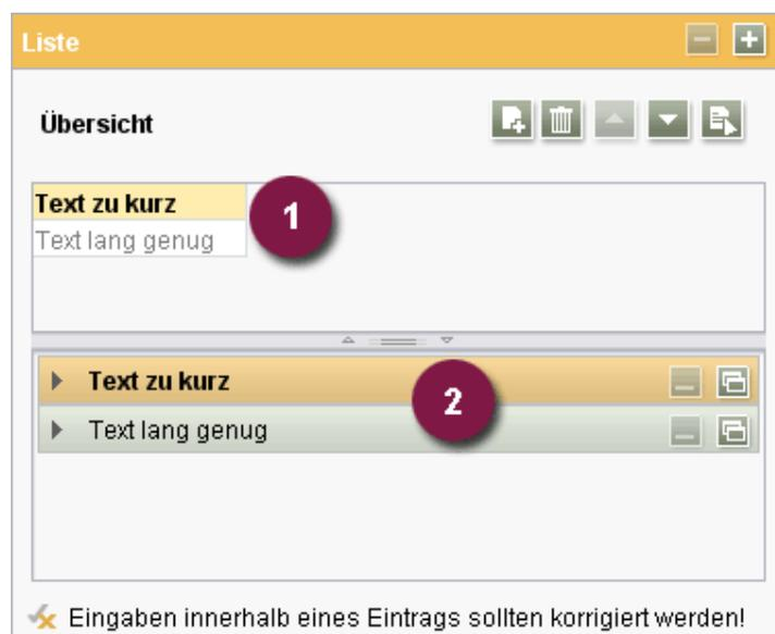
Abbildung 6-27: Markierung von fehlerhaften Einträgen in FS\_LIST
