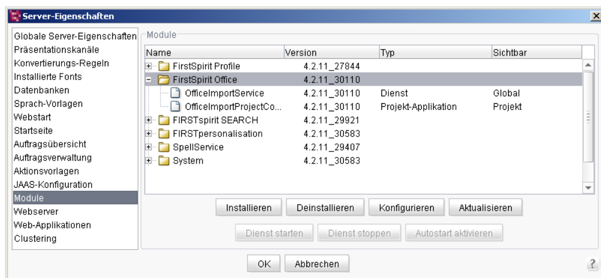
Abbildung 2-1: Installation des Moduls "FirstSpirit OfficeConnect"
