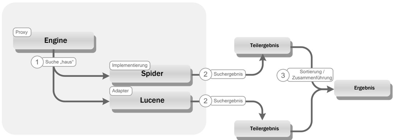
Abbildung 4-1: Suchanfrage/Suchergebnis beim Multi-Engine-Proxy
